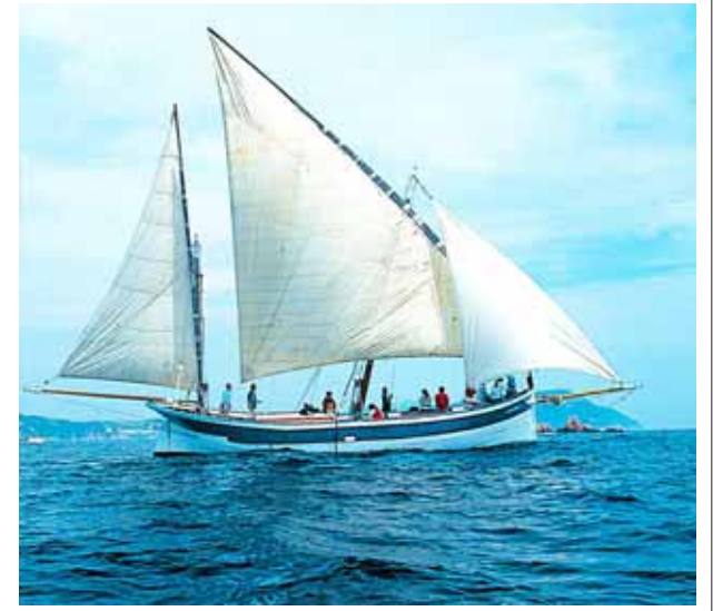
RAFAEL Una de les poques barques de navegació mitjana que solca encara les aigües de la Mediterrània. Construït el 1915, té unes dimensions de 12,90 metres d'eslora i 4,40 de mànega. A bord, hi poden anar fins a 25 passatgers. www.telamarinera.es Foto: M.Curel.
