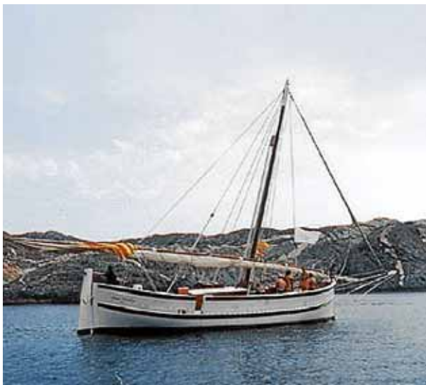
SANT ISIDRE Fabricada a Portocolom el 1925 pel mestre s'aixa Joan Creus Ensenyat, té una gran història darrere. Amb una eslora de 14,60 metres, aquesta barca fou trobada per casualitat dins una embarcació a punt de ser desballestada. www.sant-isidre.com Foto: Q.D.
